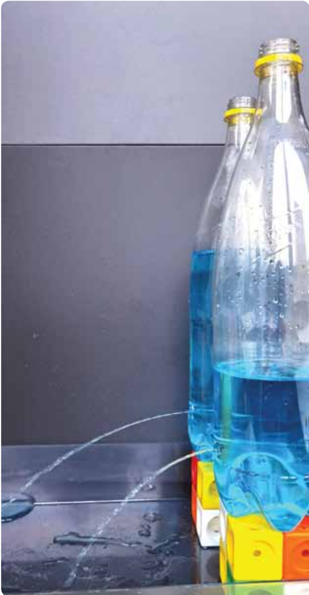
Slika 6: Iztekanje vode skozi luknjico. V plastenki v ozadju, kjer je gladina vode višje nad luknjico, voda skozi luknjico potiska večji tlak in ima curek pri iztekanju iz posode večjo hitrost kot v plastenki v ospredju, kjer je gladina vode nižje nad luknjico in voda izteka z manjšo hitrostjo.
