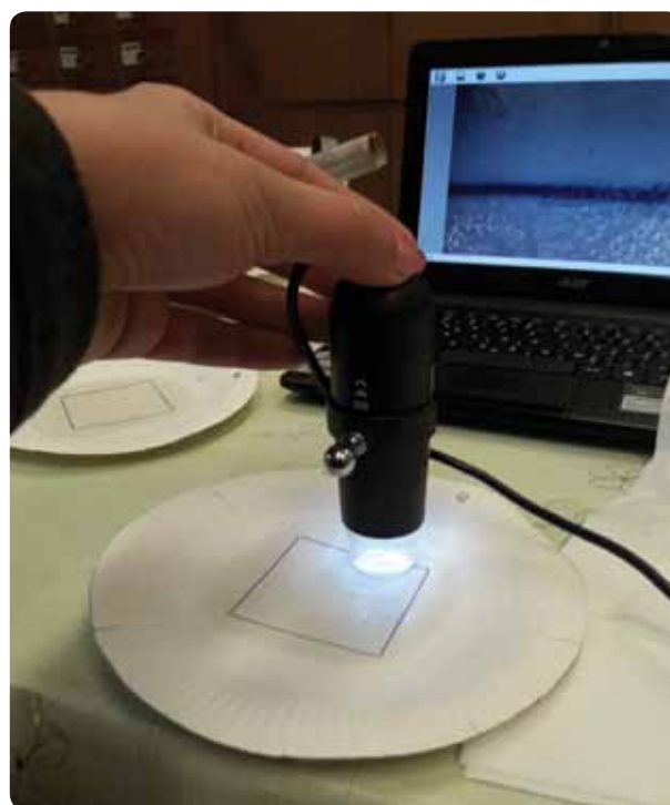
Slika 6: Štetje trdnih delcev s pomočjo USB-mikroskopa (MicroCapture)
