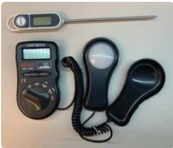
Slika 1: Vbodni termometer in merilnik osvetljenosti
