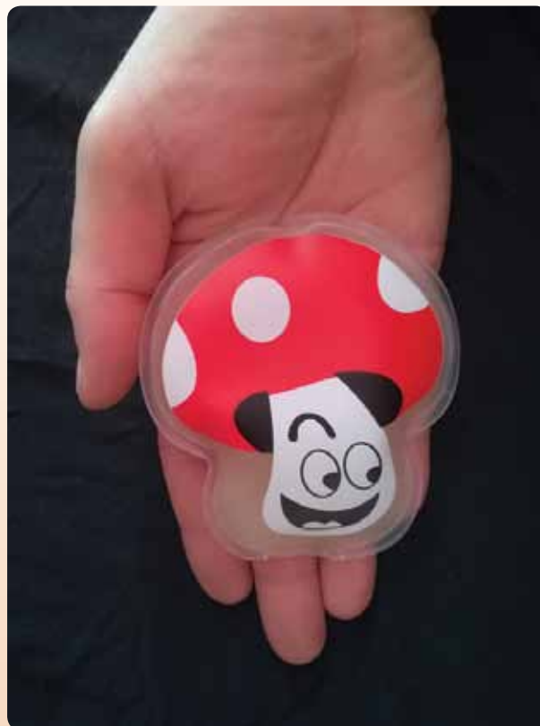
Slika 1: Ko kovinsko ploščico v grelni blazinici (žepnemu grelniku) zlomimo, tekočina prične kristalizirati. Opazimo motnost. Grelna blazinica se pri tem segreje na približno 50 °C. Toplotni tok poganja razlika temperatur. Toplota prehaja z grelnice na roko in okoliški zrak toliko časa, dokler se temperatura ne izenačijo. Za grelnico na sliki velja, da se slednje zgodi v približno 1 uri, Odvisno od začetne razlike temperatur.
