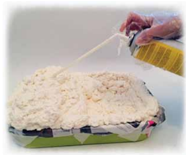
Slika 3: Iztiskanje poliuretanske pene
