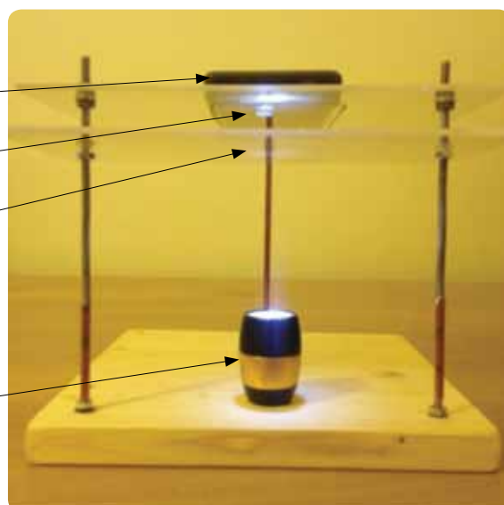
mobilni telefon leča plošča za uravnavanje razdalj luč za osvetljevanje
