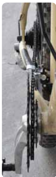
Slika 6: Komplet sprednjih in zadnjih verižnikov. Pri sprednjem je največji verižnik na zunanji strani, pri zadnjem pa na notranji strani (ob kolesu).
