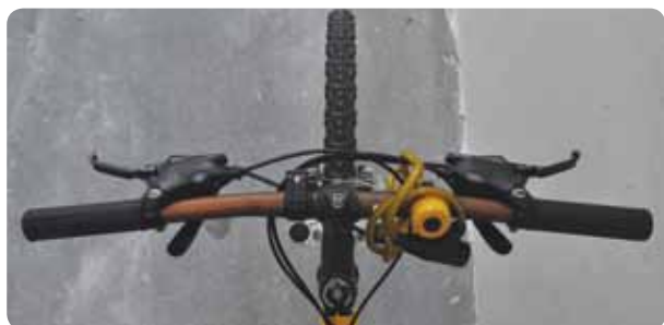
Slika 5: Krmilo s prestavnima ročicama obeh menjalnikov, prednjega – gonilnega (levo, v 2. prestavi) in zadnjega – gnanega (desno, v 4. prestavi).
