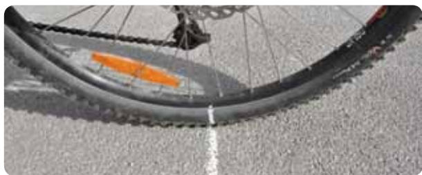
Slika 8: Merjenje poti s_1 , ki jo kolo opravi pri enem obratu kolesa.
